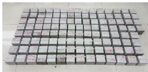
图3 相似材料结构面浇筑试件 Fig.3 Cement mortar replica specimens
